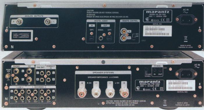
Der SACD-Spieler verfügt über einen optischen Digitaleingang, der es ermöglicht, den internen D/A-Wandler mit anderen Quellgeräten zu nutzen. Wird der Verstärker über die „P.Direct in“-Buchsen angeschlossen, agiert er als Endstufe. Als lupenreiner Vorverstärker lässt sich der Marantz PM-15S2 ebenfalls einsetzen
